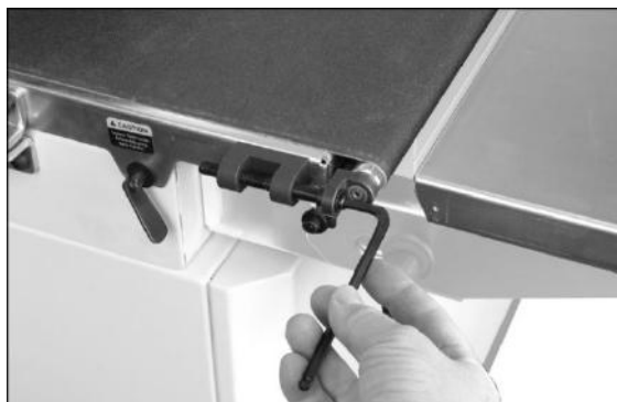
Figure 8-2: Réglage tension de courroie
