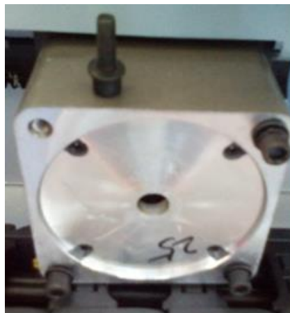
2. Vorschubmotor Mit 4 Schrauben montieren
