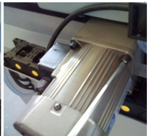
12. Moteur d'avance Poser avec 4 vis
