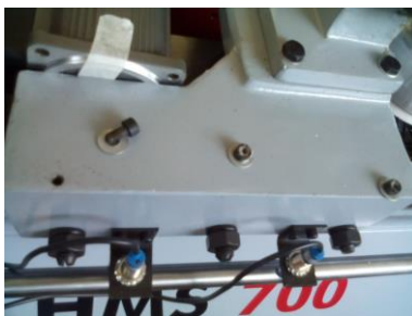
11. Moteur principal : Poser avec 4 vis
