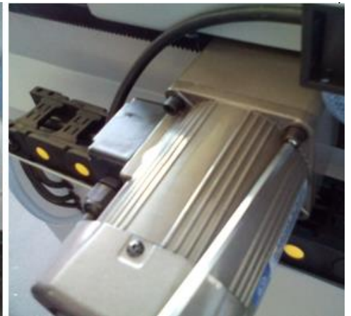
7. Motor de alimentación Móntelo con 4 tornillos
