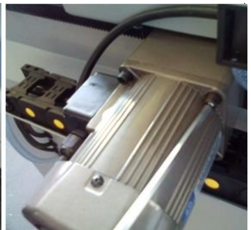
2. Vorschubmotor Mit 4 Schrauben montieren
