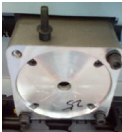
12. Moteur d'avance Poser avec 4 vis
