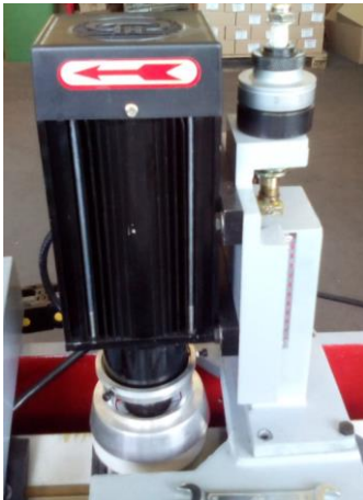
6. Motor principal: Móntelo con 4 tornillos
