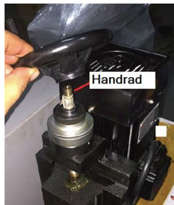
5. Handrad: Einstellhandrad auf Gewinde aufsetzen und mit Mutter befestigen
