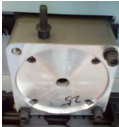
7. Motor de alimentación Móntelo con 4 tornillos
