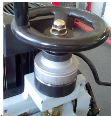
5. Handrad: Einstellhandrad auf Gewinde aufsetzen und mit Mutter befestigen
